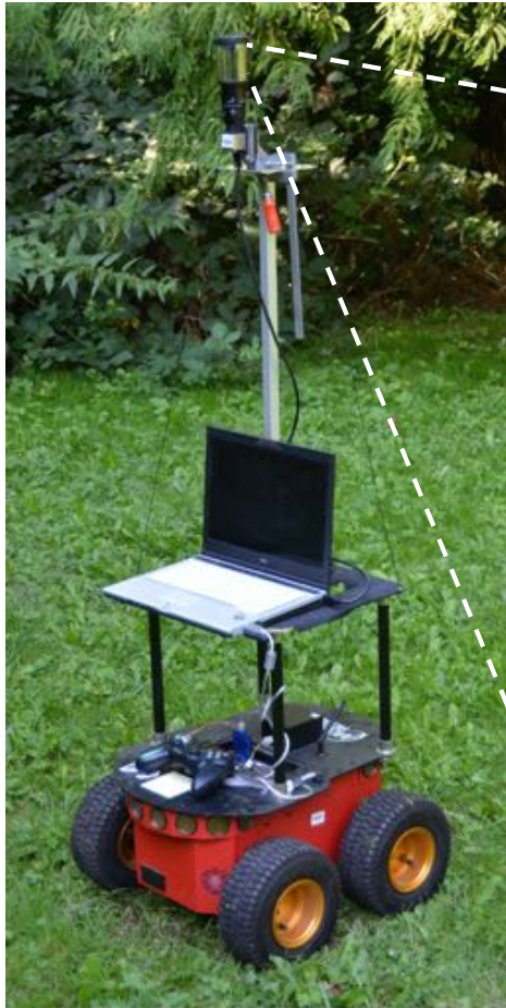
Robot mobile avec caméra omnidirectionnelle
